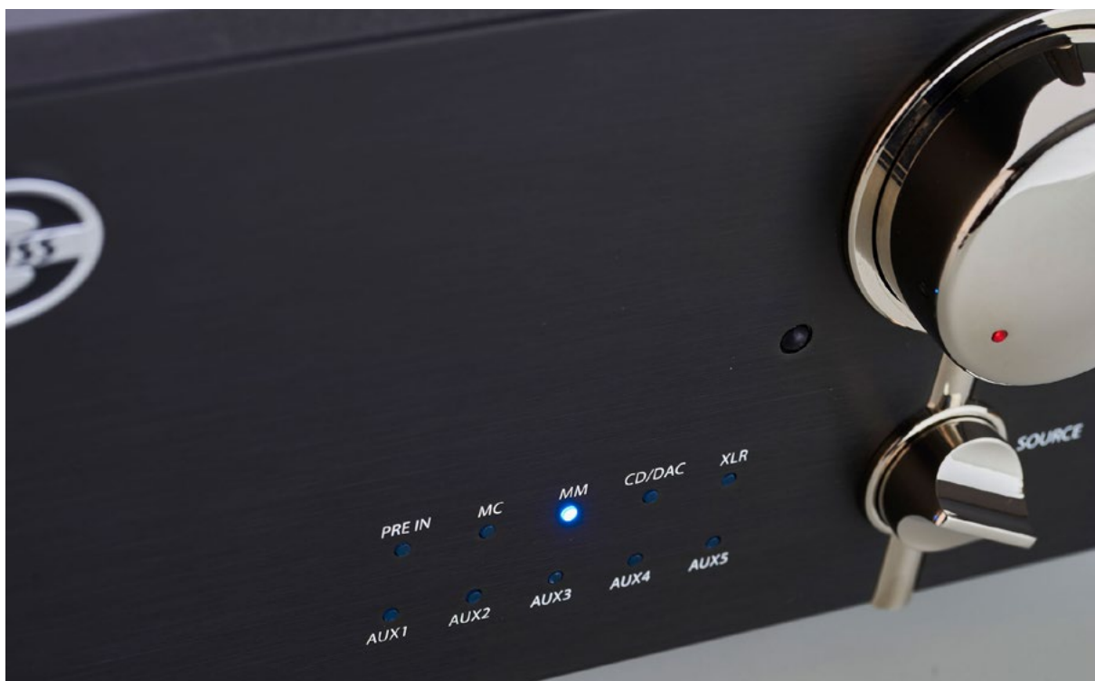
Die Funktion des Umschalters dokumentiert eine blaue nicht dimmbare LED
